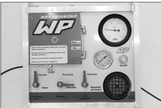
T 240S Pompe a vide et de remplissage
