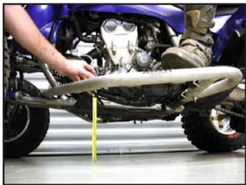
MESURE DE LA HAUTEUR DU CHÂSSIS AVANT SOUS LE SUPPORT DU MOTEUR AVANT
