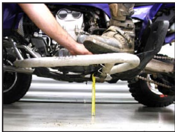
MESURE DE LA HAUTEUR DU CHÂSSIS ARRIÈRE DEVANT LE REPOSE-PIEDS
