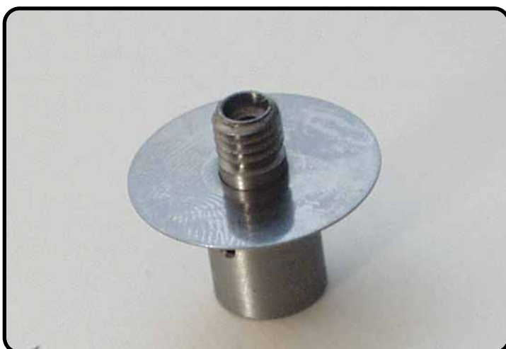
Support d'amortissement avec cales (réglage).
