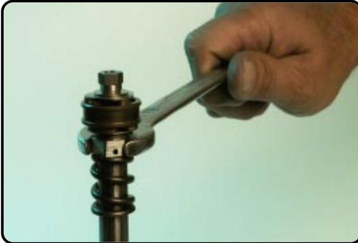
Serrez la tige de piston (au niveau de la butée hydraulique) dans T508S et dévissez le clapet de rebond. (dimension 17)
