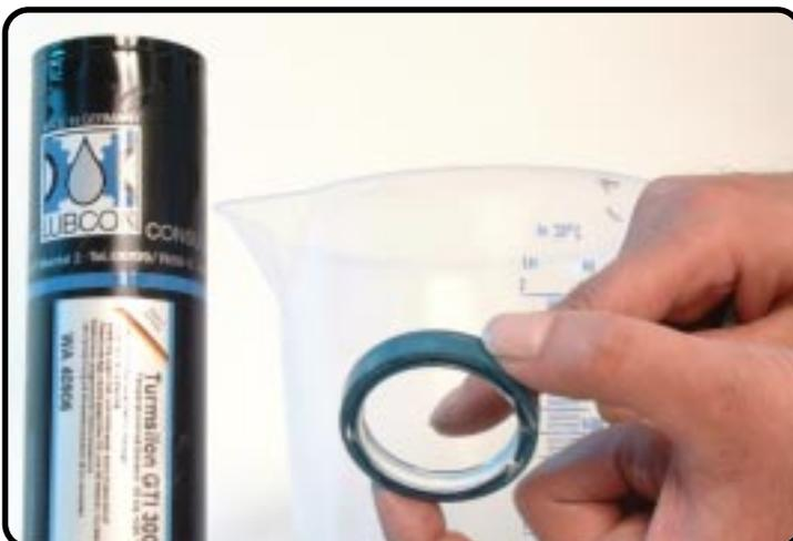
Appliquez du T511 à l'intérieur du joint d'étanchéité et de l'huile de la fourche de jambe à l'extérieur.
