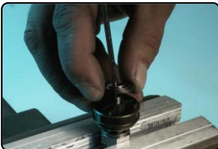
Mettez un tournevis au bout du clapet
