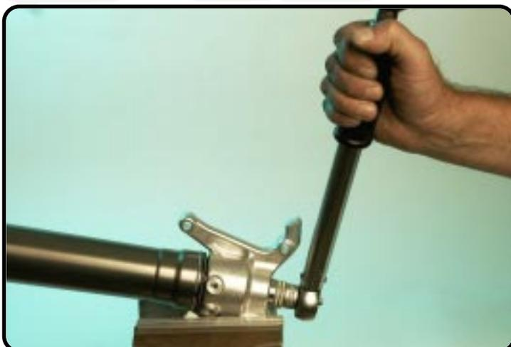
Mettez la cartouche au centre du collier de serrage et vissez le porte-injecteur jusqu'à un couple de 25Nm.
