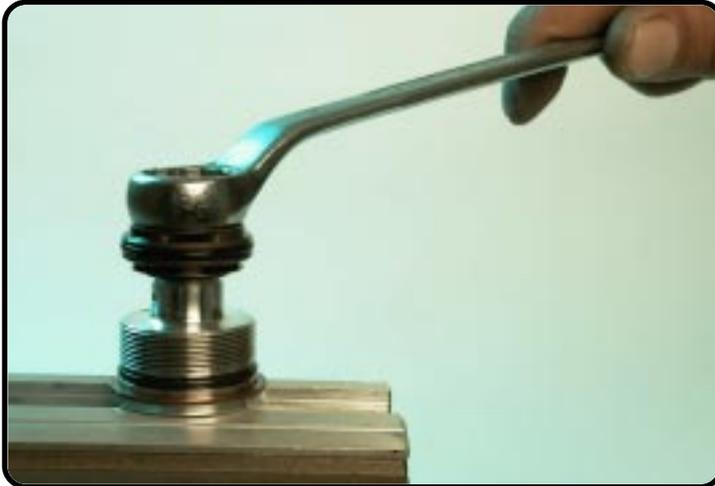
Serrez le porte-injecteur dans l'étau et dévissez l'écrou du clapet de contrôle. (dimension 17)
