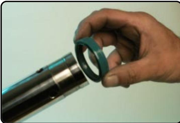
Démontez la joint d'étanchéité.
