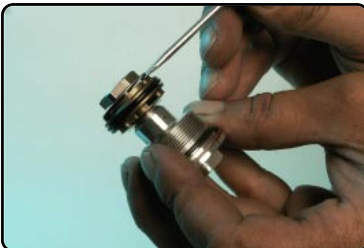
Vérifiez que le ressort est bien placé dans l'encoche de l'écrou.
