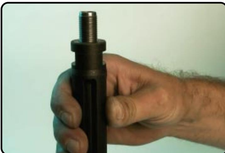
Vissez la butée hydraulique "à la main" à l'extrémité du filet de la tige de piston.
