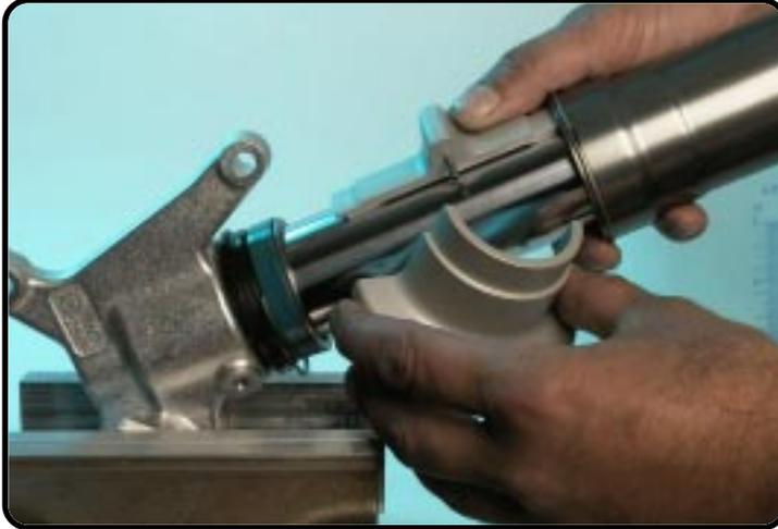
Montez la bague DU avec T1402S - du coté plat - et...
