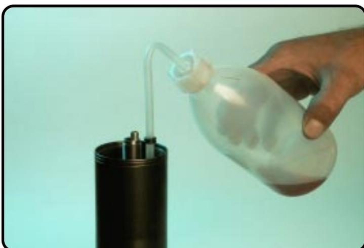
Poussez la tige de piston et le tube externe à fond et ajustez le niveau d'huile (amortisseur pneumatique) avec T137S.
