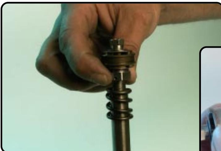
Imbibez le filet de T131 et vissez le clapet dans la tige de piston.
