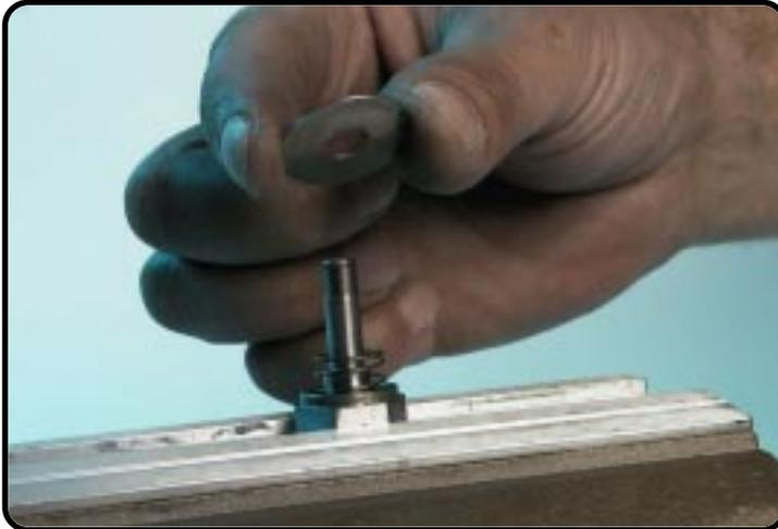
Enlevez les cales d'épaisseur du clapet de contrôle.
