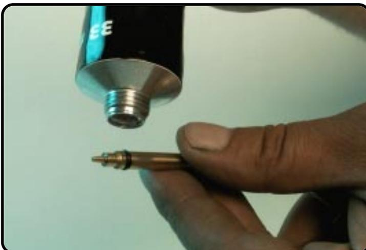
Graissez le joint torique de l'aiguille de réglage avec T158.
