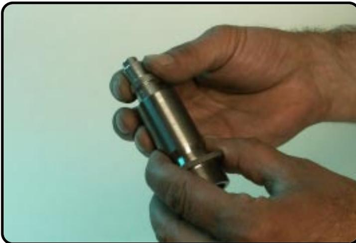
Démontez la bague DU avec T507 et sortez la de la bague filetée à l'aide de l'étau.
