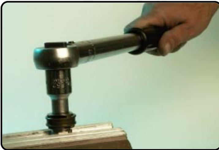
....serrez jusqu'à un couple de 5 Nm.
