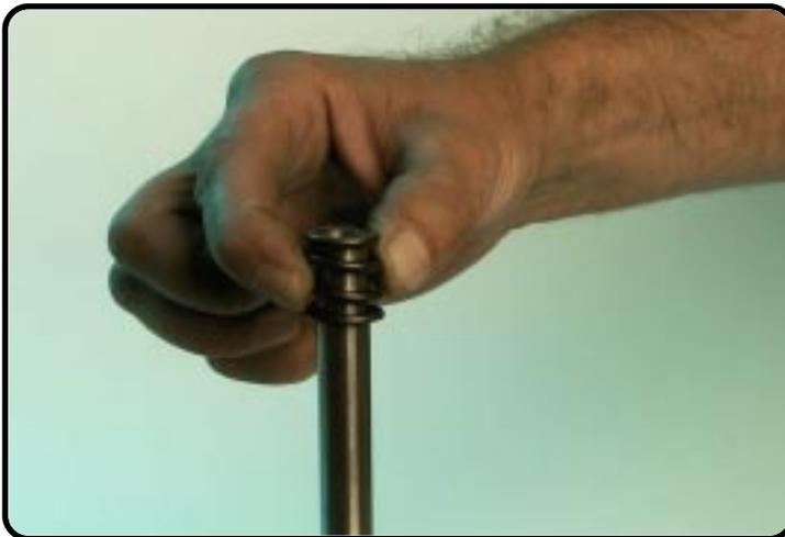
Serrez la tige de piston dans T508S au niveau de la butée hydraulique.
