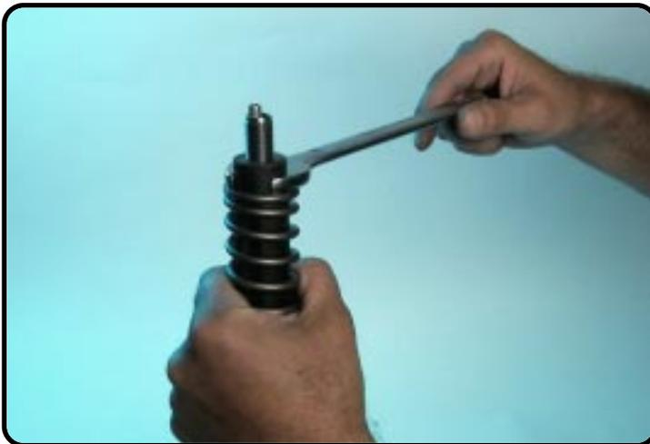
Comprimez le ressort et mettez une clé à fourche de 22 sur la butée hydraulique.
