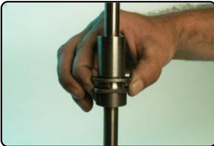
Serrez la tige de piston "mais pas trop" de l'autre coté et remplacez la bague filetée avec la coupelle d'appui du ressort.
