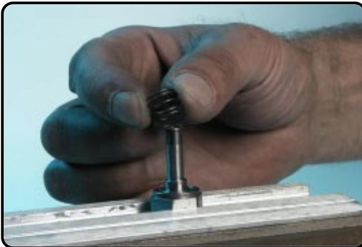
Enlevez le ressort du clapet de contrôle.
