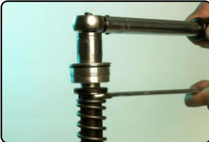
Visser le manchon, jusqu'à ce que la butée hydraulique soit contre le manchon, et serrer le jusqu'à un couple de 25Nm.
