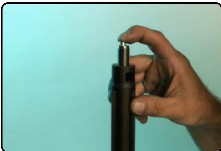
Déplacez la tige de piston (maintenir le tube de réglage en place) plusieurs fois dans les deux sens, jusqu'à sentir que la cartouche est pleine d'huile, (l'amortissement est régulier dans toute sa plage), la plupart du temps il est nécessaire de compléter (un peu) le plein d'huile dans la fourche.
