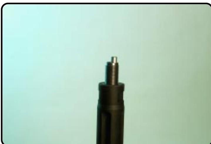
Mettez le tube de réglage avec le joint torique dans la tige de piston.
