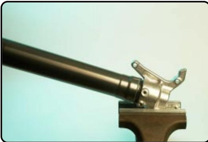
Serrez le collier de serrage dans l'étau pour que la jambe de fourche fasse un angle de  $\pm 45$  degrés.
