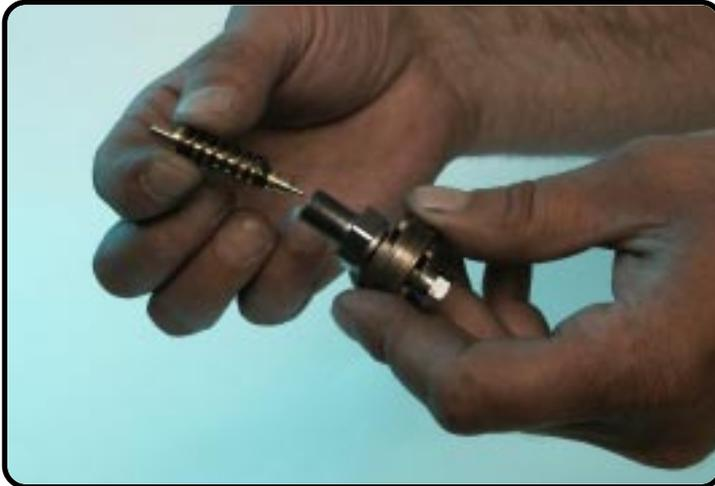
Sortez l'aiguille de rebond avec son ressort du clapet de rebond.
