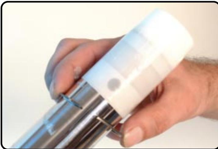
Remplacez le circlips.
