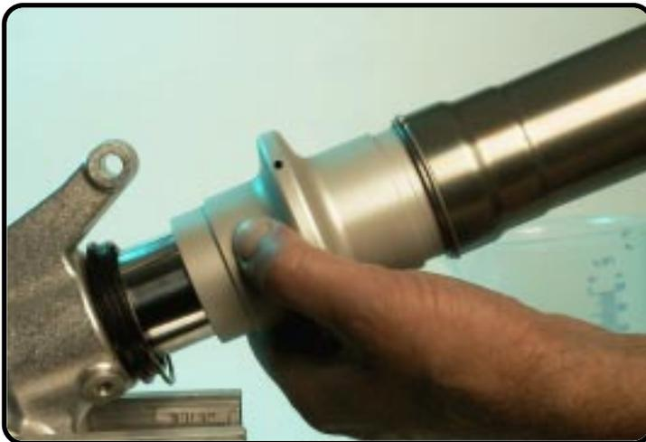
....et insérez le joint d'étanchéité dans le tube externe.
