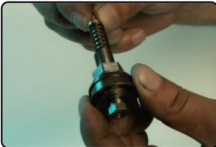
Montez l'aiguille avec son ressort dans le clapet de rebond.
