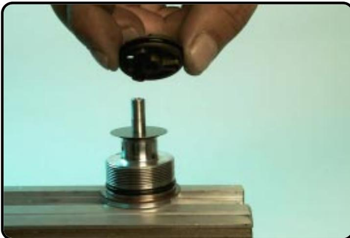
Démontez le piston de compression avec le joint torique.
