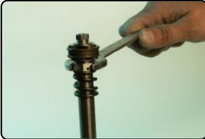
Serrez le clapet de rebond.
