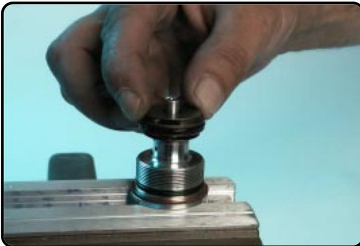
Remplacez la cale du clapet de contrôle.
