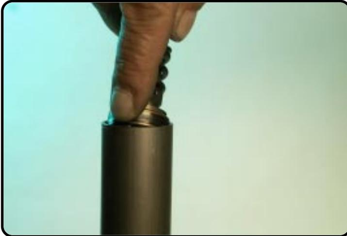
Enfoncez le tube avec le bouchon dans le bloc de serrage (T508 + T509) et montez la tige de piston "équipé" dans le tube.
