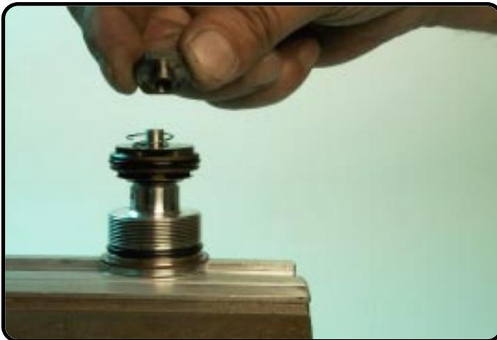
Enlevez l'écrou du clapet de contrôle.
