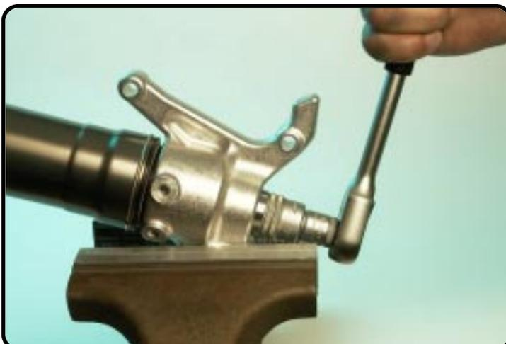
Dévissez le porte-injecteur hors du collier de serrage. (dimension 19) (si la cartouche tourne avec le porte-injecteur, cambrez la tige de piston un peu sur le coté).
