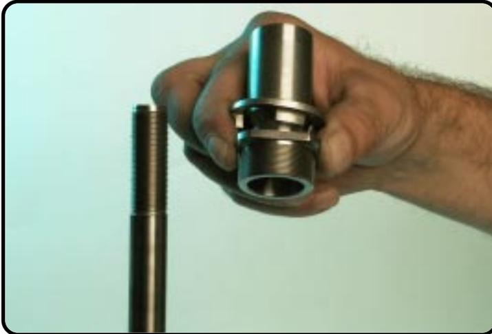
Enlevez la bague filetée avec la coupelle d'appui du ressort.
