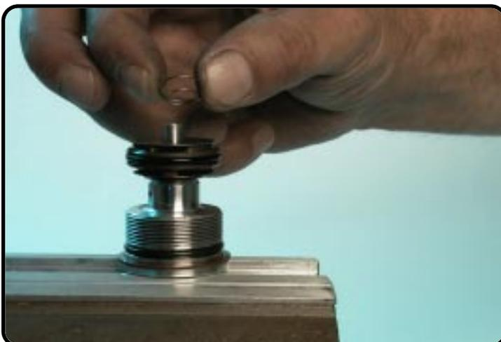
Enlevez le ressort du clapet de contrôle.
