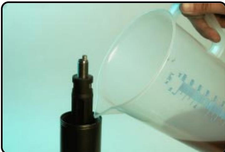
Tournez le tube externe vers le bas et sortez un peu la tige de piston (comme sur la figure), remplissez la fourche de jambe d'huile jusqu'à ce qu'elle affleure le bord du tube externe, laissez reposer et attendez de voir des bulles d'air à sa surface.
