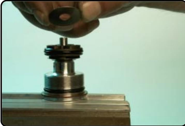
Enlevez la cale d'épaisseur du clapet de contrôle.
