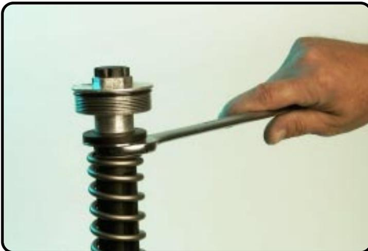
....et placer la clé à fourche (dimension 22) sur la butée hydraulique.
