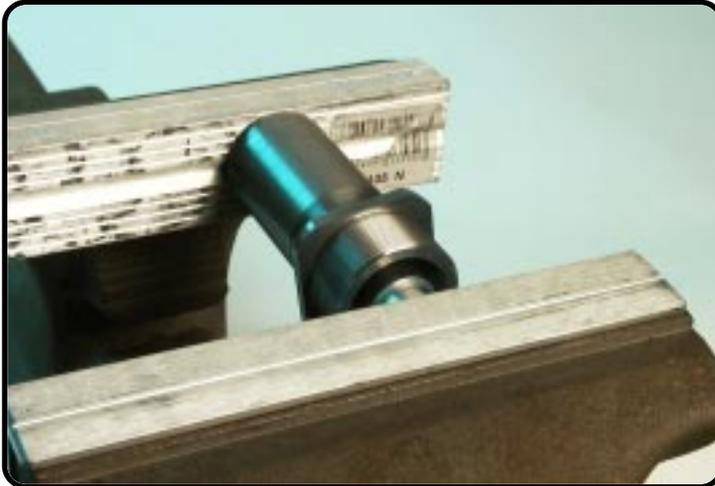
Enfoncez la bague DU dans la bague fileté avec T507.
