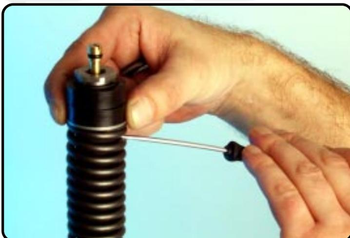
Mettez la rondelle en acier et les bagues de pré-tension.
