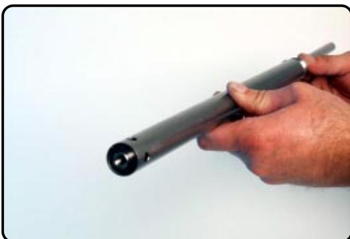
Enfoncez le clapet à l'aide de la tige du piston à hauteur du circlips.
