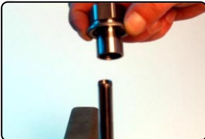
Enlevez la douille à vis et la coupelle d'appui du ressort.
