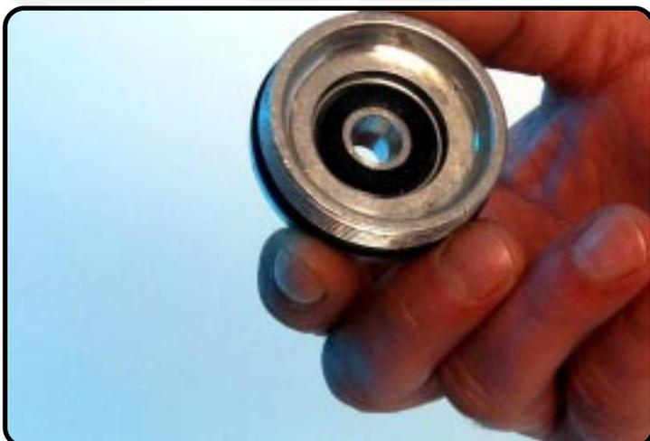
Vérifiez le joint d'étanchéité en caoutchouc interne.
