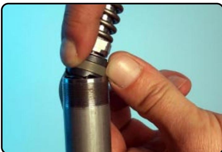
Placez la tige du piston "équipé" avec le segment du piston dans le tube.
