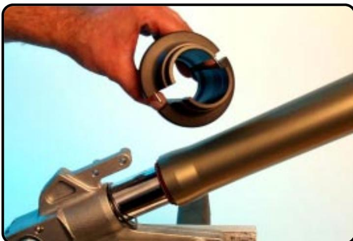
Remontez la bague DU avec T635S – avec le coté plat- dans le tube externe.
