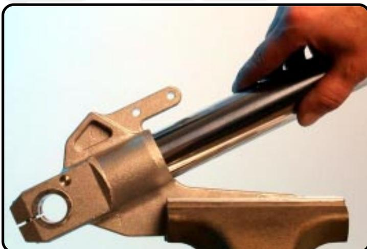
Serrez le support d'axe dans l'étau et montez le tube interne.
