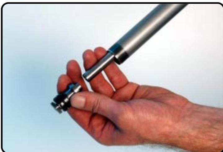
Serrez le clapet dans T639S.
