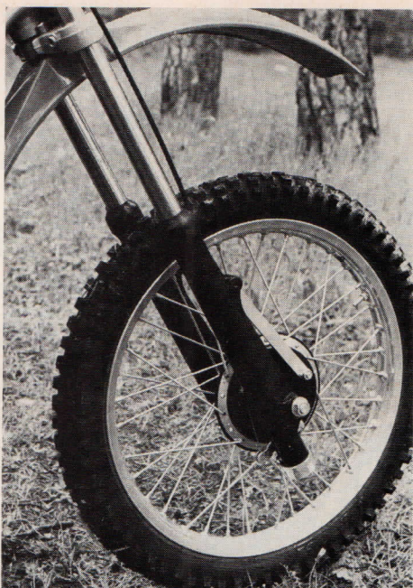
Cériani, le « roi de la fourche moderne » a également conçu, à partir de 77, des fourches à grand débattement et axe déporté. Cela avant de faire faillite !
