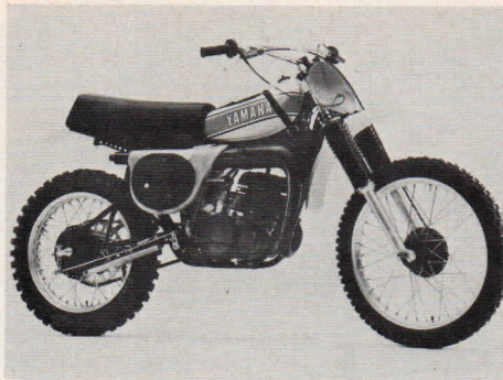
La 250 Yamaha YZ 73 a permis à Andersson de conquérir la couronne mondiale. Elle inaugurerait l'ère des suspensions arrière monoshock. A l'époque le cantilever était constitué d'un treillis tubulaire en acier. L'aluminium ne viendra que plus tard. Remarquez la simplicité de la fourche avant. Les débattements étaient fabuleux pour l'époque : 200 mm AV et 160 mm AR !
